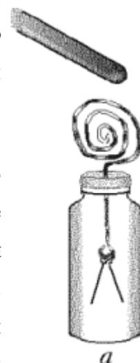
14. Коснитесь заряженной палочкой металлического стержня электроскопа – его листочки разойдутся и останутся в этом положении. Это означает, что мы передали заряд листочкам. Снова наэлектризуйте палочку и опять дотроньтесь до электроскопа – его листочки отклонятся на больший угол, т.к. заряд на электроскопе увеличился.
