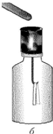
Поставьте на крышку электроскопа перевернутую металлическую консервную банку (рис. б). Вновь поднесите заряженную палочку, не касаясь банки. Листочки электроскопа никак не отреагируют на электрическое поле. Это означает, что внутри металлической банки электрического поля нет. По этой причине корпуса многих приборов металлические – они экранируют приборы от внешних электрических полей, помех, нежелательных сигналов.
